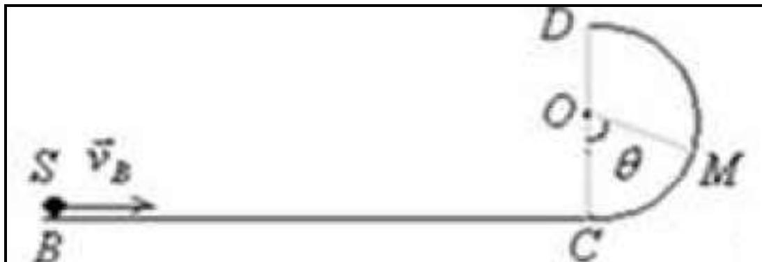
1- نرسل جسمًا نقطيا S كتلته g = 200 m من نقطة B بسرعة  $v_B = 200 \text{ m/s}$ . نعتبر أن قوة الاحتكاك تبقى ثابتة طول الجزء BC شدتها f.
